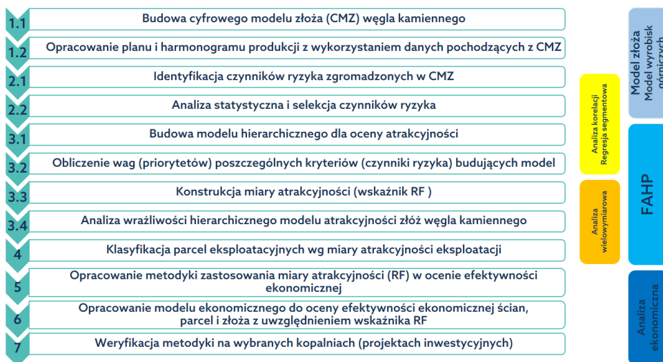
Rys. 6.1. Etapy badawcze zaproponowanej metodyki (opracowanie własne)
