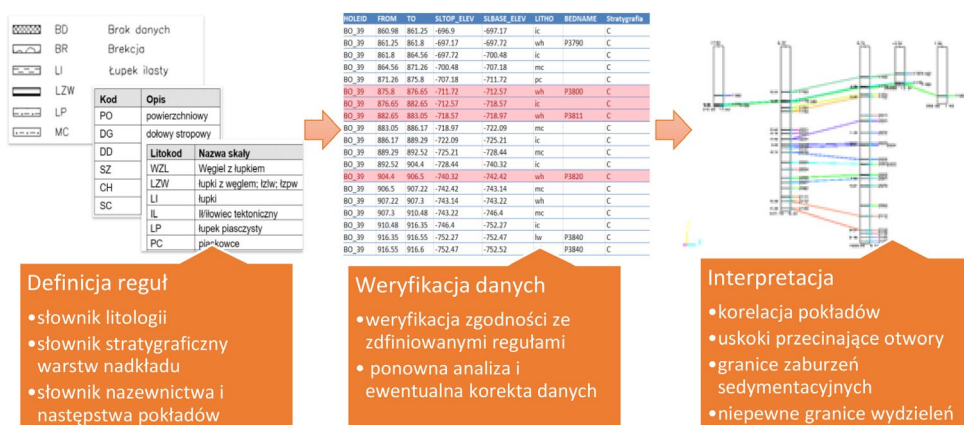
Rys. 4.4. Schemat przygotowania danych geologicznych do modelownia złoża węgla kamiennego (opracowanie własne)
