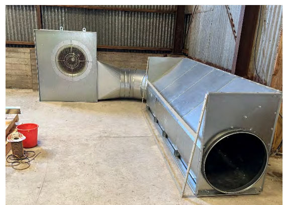
Ryc. 3.3.3. Wykorzystanie ciepła geotermalnego jest często osiągnięte przy użyciu bardzo podstawowego sprzętu. Na zdjęciu orurowanie zastosowane w suszarce – zdjęcie z projektu dofinansowanego przez Orkusjóður
