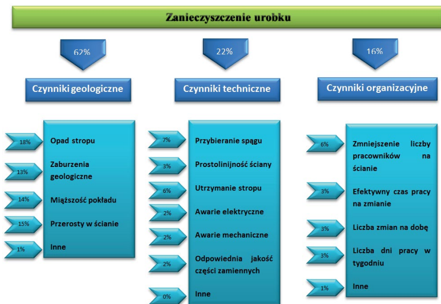
Rys. 4.55. Wpływ czynników na zanieczyszczenie urobku w ścianach strugowych (opracowanie własne)
