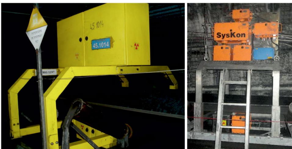
Rys. 4.8. SysKon400, system ciągłej kontroli parametrów jakościowych węgla w LW Bogdanka SA (Dyczko i in. 2015)
