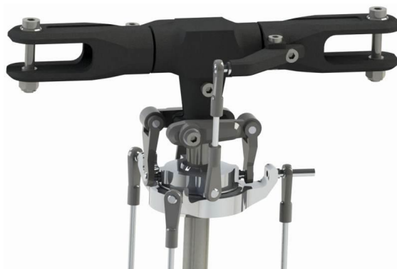
Rysunek 12. Mechanizm zmiany skoku śmigłowca RC
