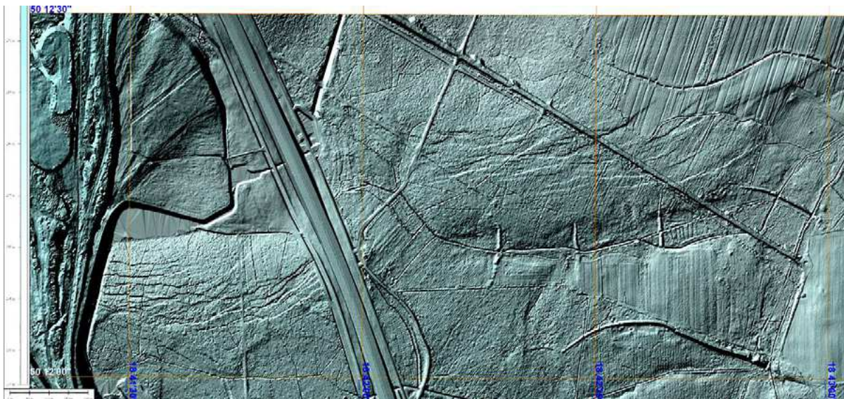
Rys. 2.4.14. WMT lidarowy; M34-62-A-d-3-2 i 4-1-GrSh; wycinek rys. 2,4,11; siatka geograficzna 30"; hałdy, niecki osiadania, spękania i infrastruktura komunikacyjno-transportowa; bezpośrednio na „szkodach górniczych”; przybliżenie fragmentu rys. 2.4.11; teren SMGP Gliwice 941
