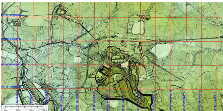
Rys. 1.5.3a. M34-62-A-c i d, WMT lidarowy; fragment arkusza SMGP Gliwice 941; niecki osiadania, zapadliska i stawy powyrobiskowe; (w) obszary intensywnej działalności przemysłu górniczego (g); Knurów, obszar SMGP arkusz Gliwice 941; siatka geograficzna 1; we wcięciu; siatka 15"; dwie grupy hałd i nieczynnych szybików (sz)
