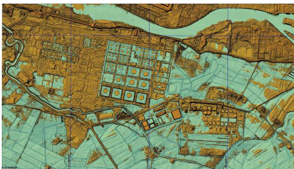
KL 2.1.6. N34-50-C-d-4-4 i D-c-3-3; WMT lidarowy; tereny uprzemysłowione na obrzeżach dużej aglomeracji mieszkaniowo-turystycznej; znaczna część u dołu obrazu jest zlokalizowana w depresji, utrzymywanej w stanie suchym przez system sieci drenażu, śluzy i przepompownię; siatka geograficzna 1'
