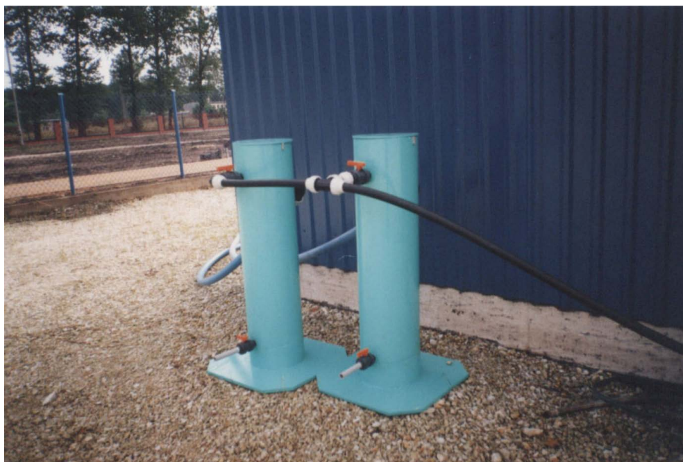
Rys. 19. Stanowisko badawcze do poboru materiału piaszczystego przy otworze Mszczonów IG-1 (Bujakowski i in. 2004)
