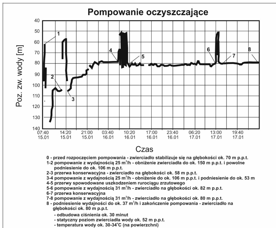
Rys. 10. Wyniki pompowania oczyszczającego (Barbacki i in. 2000)
