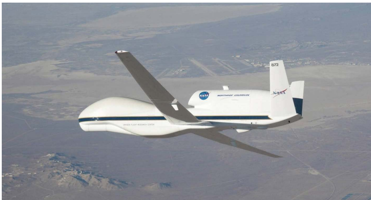
Rys. 2.73. Samolot bezzałogowy Global Hawk (NASA), o długości 13,41 m i 35,35 m rozpiętości skrzydeł z zainstalowanymi na pokładzie urządzeniami rejestracyjnymi od wideo HD po czujniki ozonu. Przeznaczony do badania składu chemicznego atmosfery przyziemnej troposfery, jak i stratosfery, chmur i aerozoli stratosferycznych. Będzie przystosowany do harmonizowania obserwacji satelitarnych Aura z bezpośrednimi obserwacjami z własnych czujników; na zdjęciu w locie testowym 23.10.2009 przed lądowaniem w Kalifornii; [http://www.nasa.gov/feature/nasa-global-hawk-departs-wallops-for-erika; https://www.nasa.gov/centers/dryden/pdf/331057main_AUVSI.pdf]. NASA Photograph by Carla Thomas; http://eoimages.gsfc.nasa.gov/images/imagerecords/43000/43291/globalhawk_2009296_lrg.jpg]
