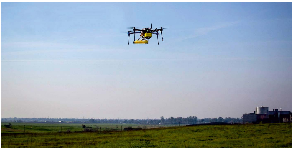
Rys. 2.72. Wykorzystanie jednostek latających bez pilota (small unmanned aerial system (SUAS)) do kontroli rejestrowania zawartości metanu w atmosferze, tu badanie szczelności gazociągów; zdjęcie z testów uniwersyteckich; University of California, Merced; dla potrzeb NASA; [ http://www.jpl.nasa.gov/news/news.php?feature=6192&utm_source=iContact&utm_medium=email&utm_campaign=NASAJPL&utm_content=daily20160328-2 ]
