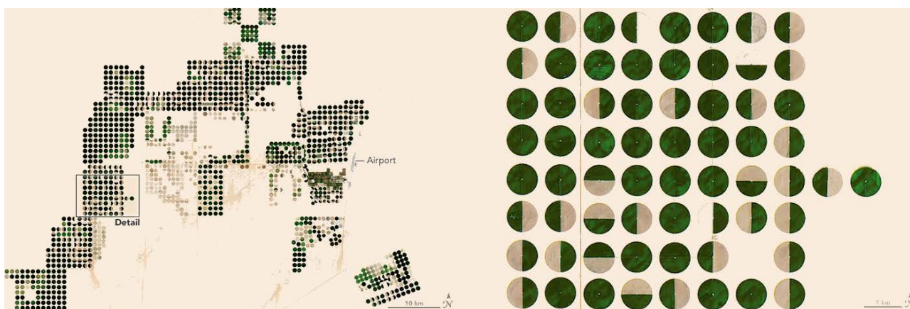
Rys. 3.35. Wykorzystywanie kopalnych wód plejstoceno-holoceńskich pompowanych spod pustyni do nawadniania pól na Saharze, na pograniczu egipsko-sudańskim; wielkość rocznych opadów deszczu jest tam rzędu kilkunastu milimetrów; średnica obszarów objętych nawadnianiem jest rzędu 800 m; po prawej powiększenie obszaru prostokąta, „detail” po lewej. Credit: USGS EROS Data Center; [ https://earthobservatory.nasa.gov/IOTD/view.php?id=2237&eocn=image&eoci=related_image ]
