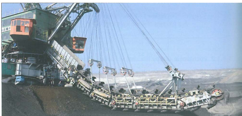
Rys. 11. Urabianie koparką łańcuchową
