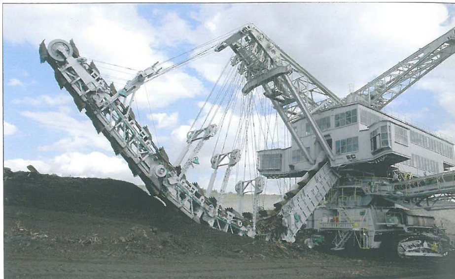
Fot. 2. Koparka łańcuchowa Źródło: Kasztelewicz
