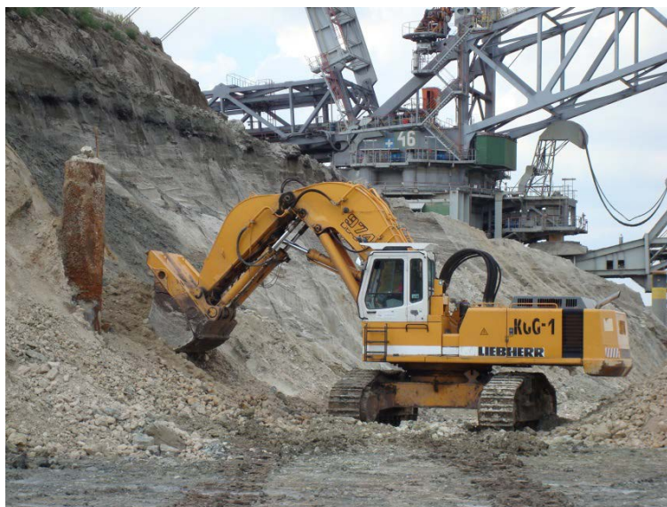
Fot. 3. Koparka łyżkowa hydrauliczna
