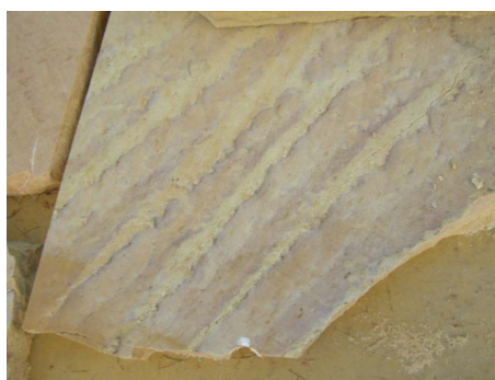
Fot. 7.2. Płyta piaskowca ze złoża Wolica II w przekroju podłużnym do uławicenia, z widocznymi jasnymi smugami związanymi z koncentracją drobniejszej frakcji w zagłębieniach między riplemarkami
