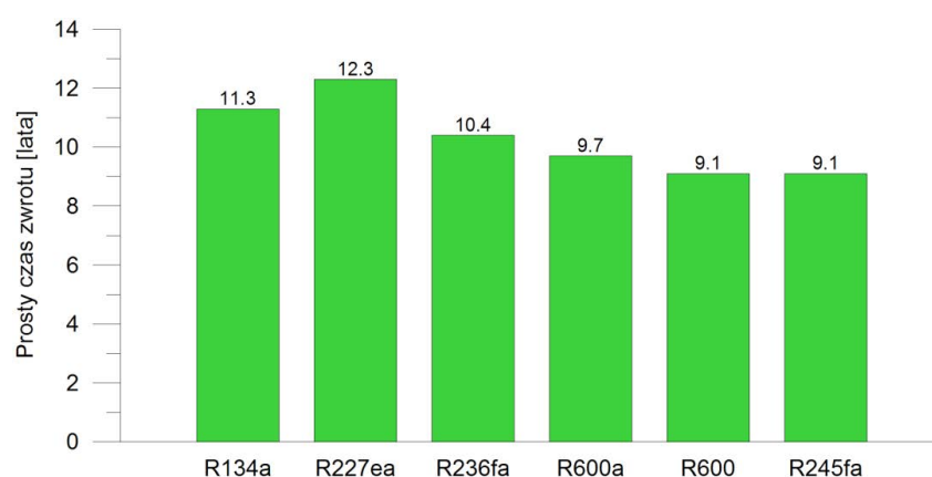
Rys. 7.5. Prosty czas zwrotu analizowanej elektrowni binarnej ORC w zależności od stosowanego czynnika roboczego (opracowanie własne)
