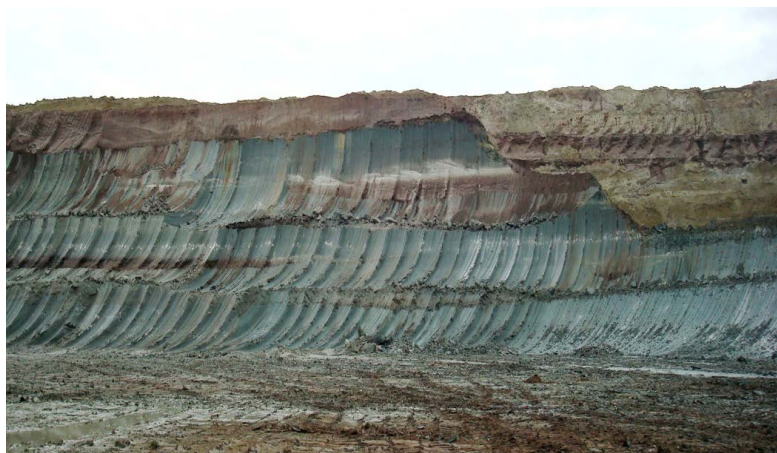
Fot. 5. Złoże węgla brunatnego „Belchatów”. Iły beidellitowe z kompleksu ilasto-piaszczystego (fot. P. Bożęcki)
