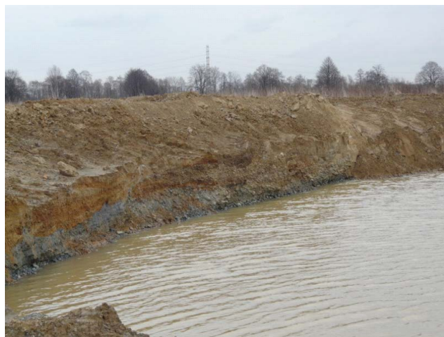
Fot. 12. Złoże kruszywa „Bielany przy Sole”. Nadkład mad rzecznych zdejmowanych w celu udostępnienia pokładu żwiru (fot. P. Bożęcki)
