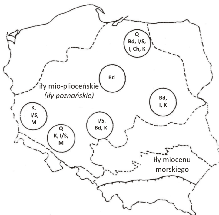
Rys. 14. Zróżnicowanie składu mineralnego ilów serii poznańskiej w czterech obszarach zalegania wg L. Stocha (1974) i Z. Wichrowskiego (1981) Objasnienia: Bd – beidellit, Ch – chloryt, I – illit, K – kaolinit, M – mika, Q – kwarc, S – smektyt, I/S minerały mieszanopakietowe illit-smektyt
