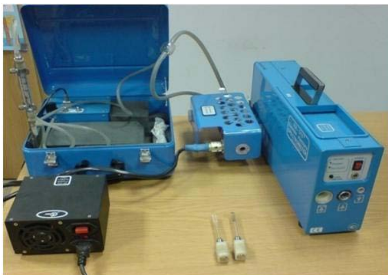
Rys. 2. Spektrometr do oznaczania zawartości rtęci Lumex RA-915+ wraz z przystawką RP-91C
