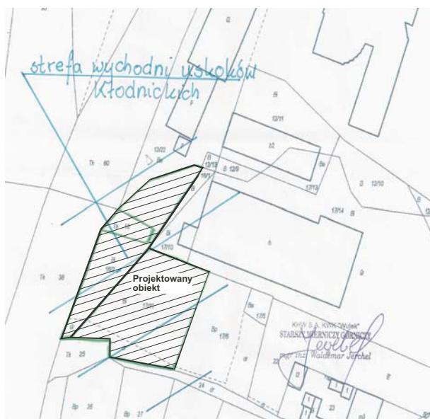
Rys. 1. Fragment mapy sytuacyjnej powierzchni OG KWK „Wujek” z naniesionym obszarem wschodni uskoku kłodnickich (Informacja KWK Wujek)
