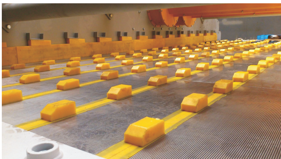
Rys. 6a. Przesiewacz wibracyjny PWP1-2,4 × 5,25
