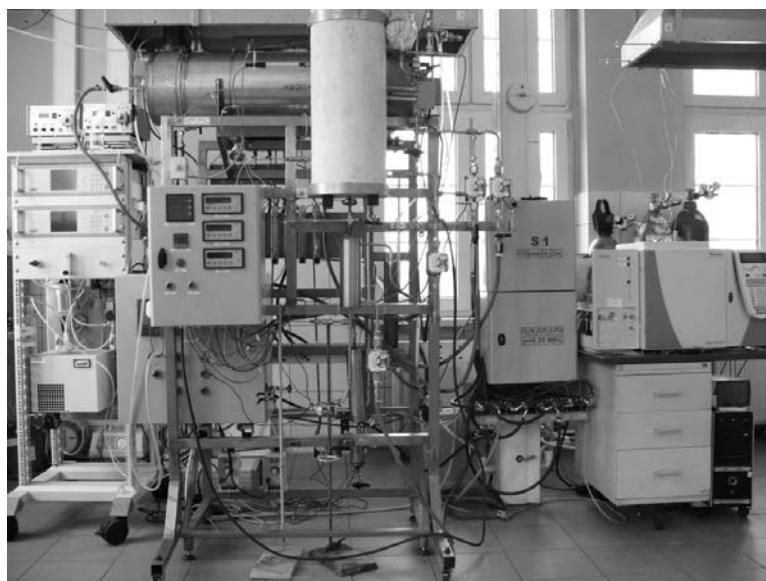
Rys. 2. Stanowisko do badania procesu wysokotemperaturowej konwersji związków smołowych w modelowym gazie ze zgazowania węgla
