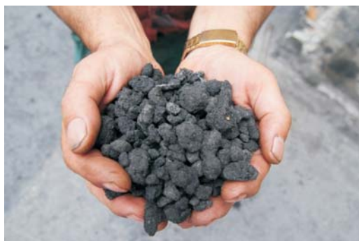
Fot. 5. Granulat mułowy uzyskany na instalacji w ZG Sobieski w Jaworznie
