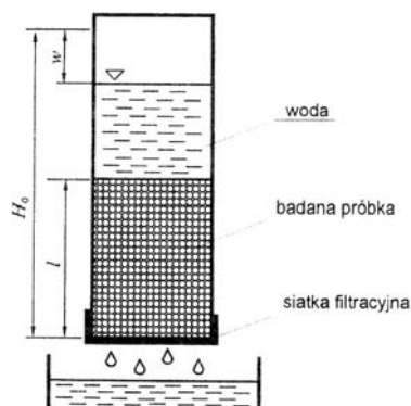
Rys. 1. Permeometr Kamińskiego ze swobodnym wypływem [3]
