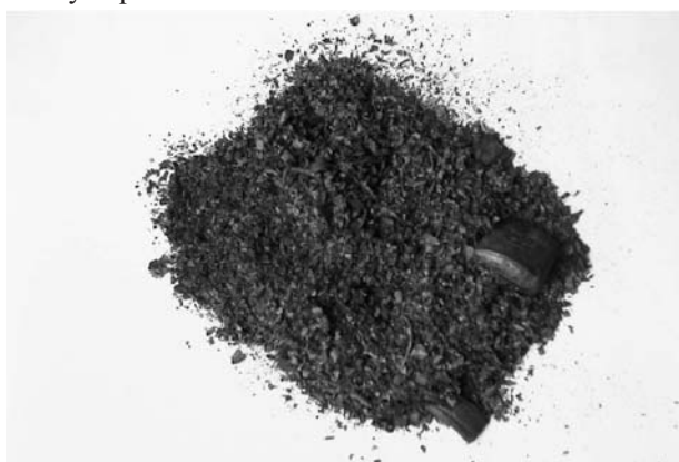
Rys. 1. Biocarbon uzyskany w wyniku autotermicznej waloryzacji paliwa
