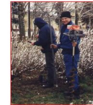
Montaż rejestratorów w gruncie na gł. 1,5 m (teren nad wysadem solnym)
