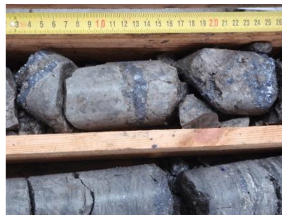
Rdzeń wiertniczy z okruszczeniem minerałami cynku i ołowiu.
