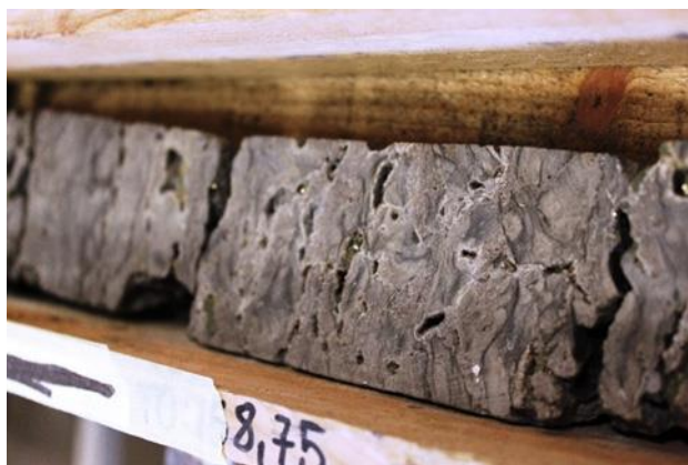
Rdzeń wiertniczy z okruszczeniem minerałami cynku i ołowiu.
