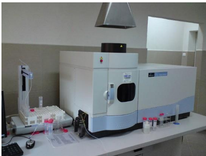
Spektrometr emisyjny z plazmą wzbudzoną indukcyjnie ICP OES Optima 7000 DV (Perkin Elmer)
