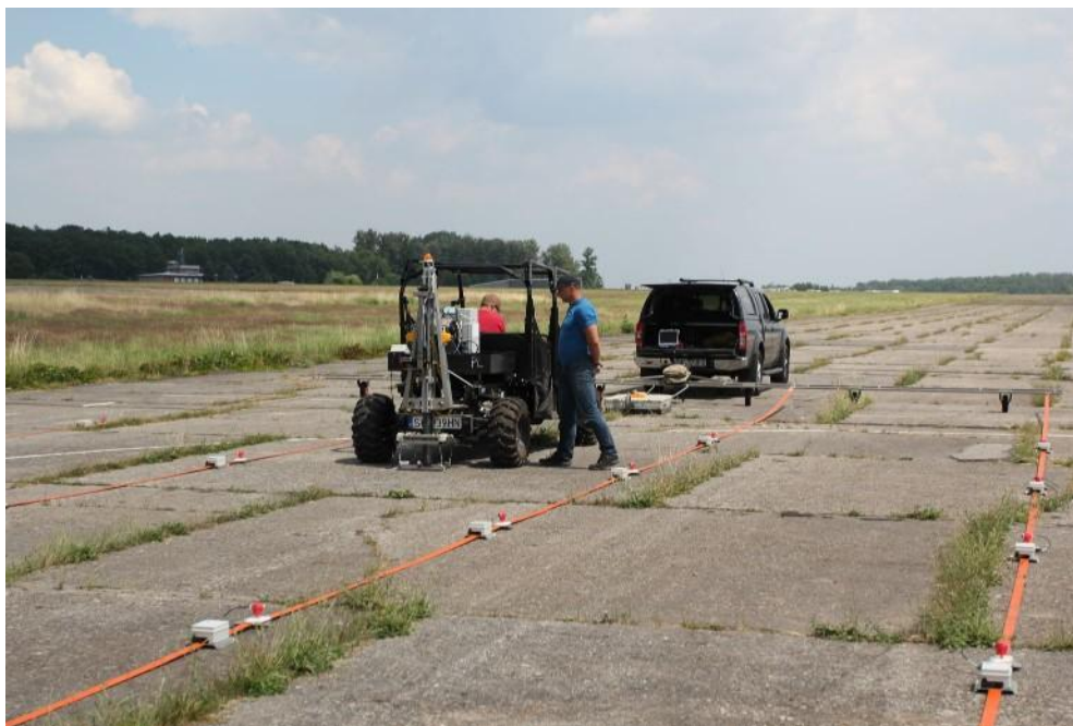
Pomiar systemem Seismobile na lotnisku w Muchowcu
