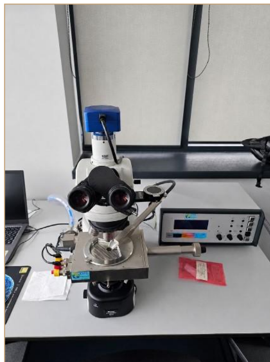
Mikroskop polaryzacyjny Nikon Eclipse Ci-L
