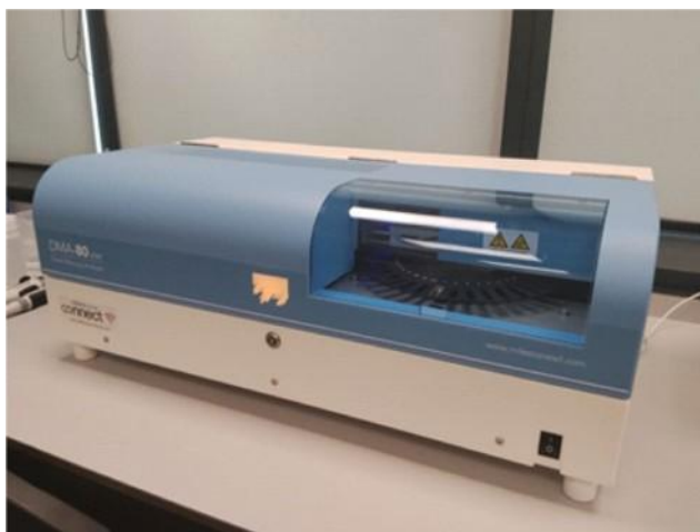
Spektrometr absorpcji atomowej dedykowany do oznaczania rtęci, analizator DMA-80 (Milestone), Laboratorium Kompleksowych Badań Odpadów i Biomasy
