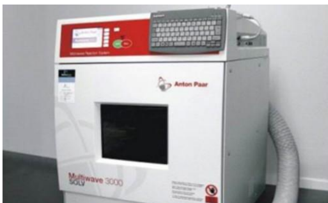
Mineralizator mikrofalowy Multiwave 3000 (Anton Paar)
