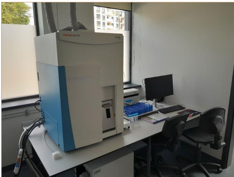
Spektrometr mas z plazmą wzbudzoną indukcyjnie ICP-MS iCAP RQ (Thermo Scientific)
