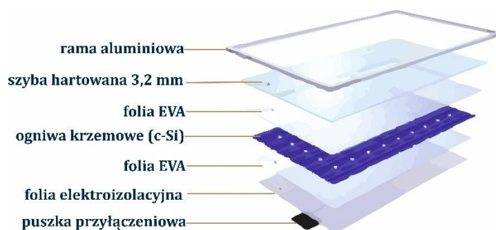
Rysunek 6. Budowa panelu fotowoltaicznego (Selfa, 2024)
