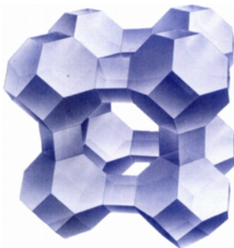
Rys. 1. Model przestrzennego połączenia kuboooktaedrów w zeolicie typu A ( http://www.molecularsieve.org )
