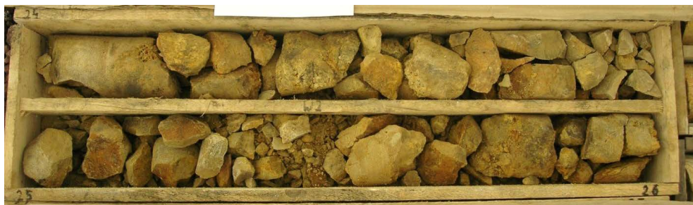
Fot. 3.1. Bardzo słaba jakość górotworu, RQD ≤ 25%
