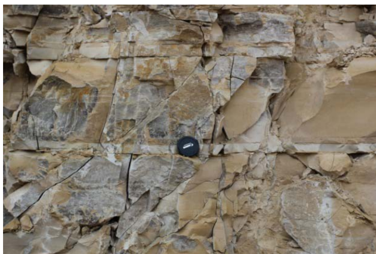
Fot. 5.2. Systemy spękań masywu dolomitu w strefie mniej zwietrzałej w rejonie Piekar Śląskich (fot. Z. Pilecki)
