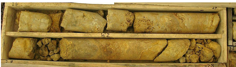
Fot. 3.3. Średnia jakość górotworu, 50 < \text{RQD} \leq 75\%
