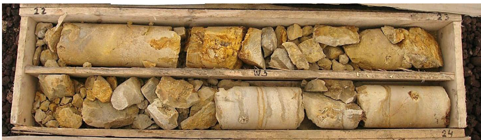
Fot. 3.2. Słaba jakość górotworu, 25 < \text{RQD} \leq 50\%
