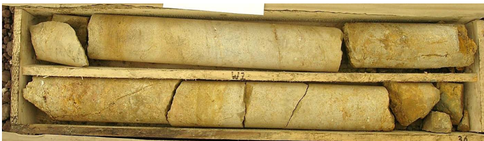
Fot. 3.4. Dobra jakość górotworu, 75 < \text{RQD} \leq 90\%
