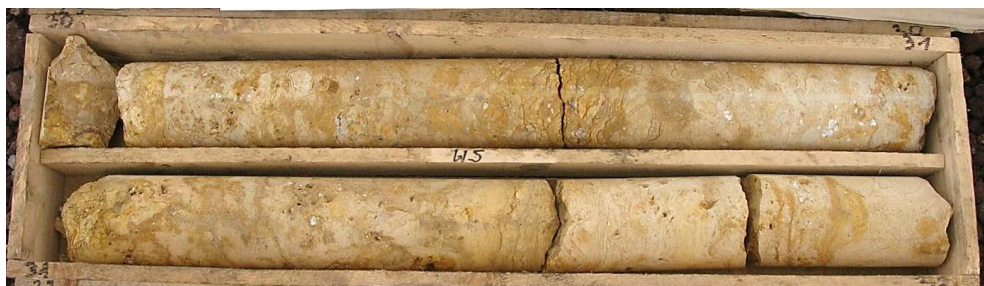
Fot. 3.5. Bardzo dobra jakość górotworu, 90 < \text{RQD} \leq 100\%
