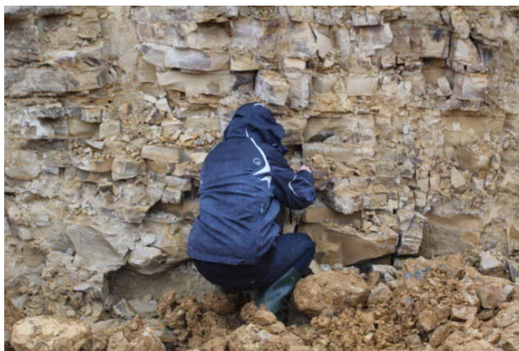
Fot. 5.1. Systemy spękań masywu dolomitu w strefie wietrzenia w rejonie Piekar Śląskich (fot. Z. Pilecki)
