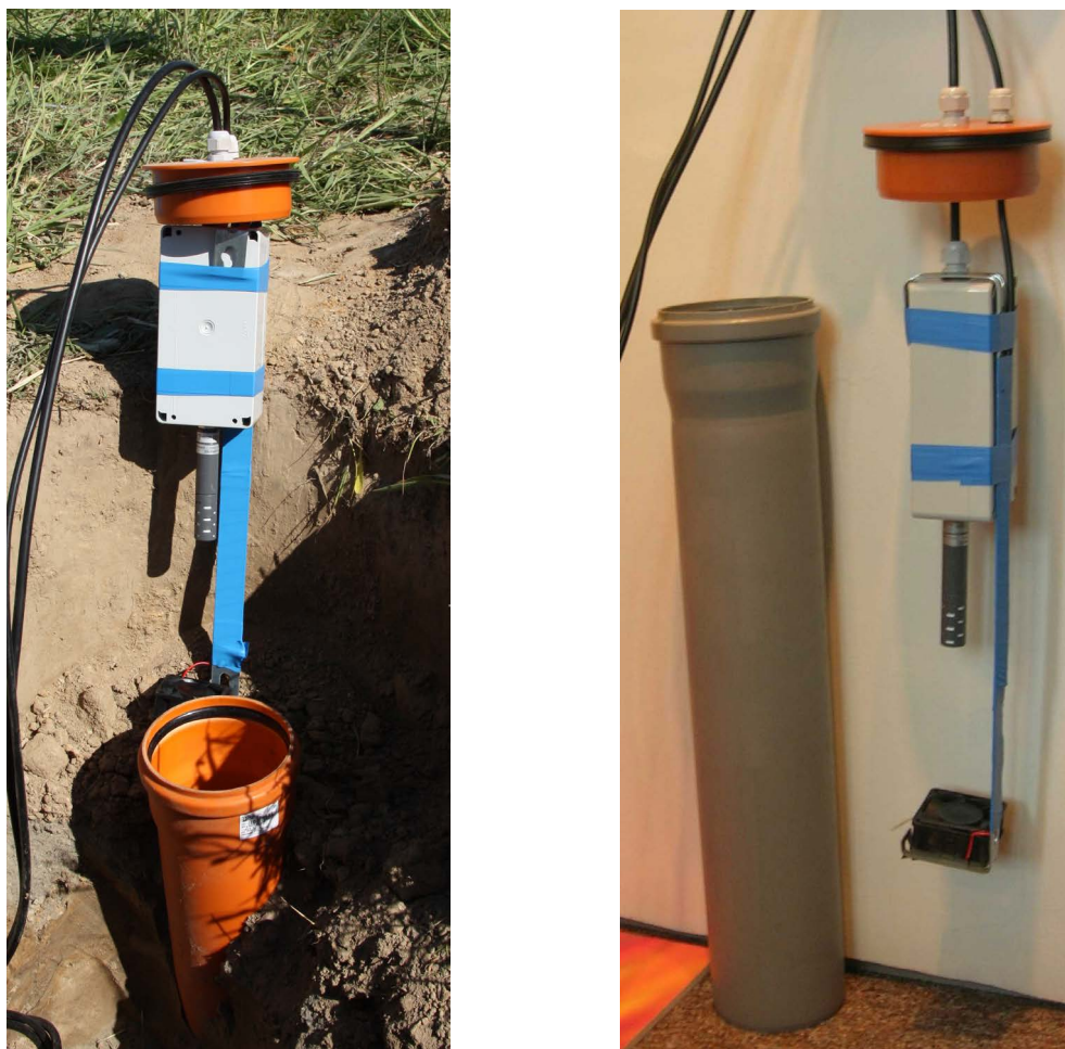
Rys. 9. Fotografia sondy pomiarowej i zabudowy sondy. Pracownia Geotechnologii IGSMiE PAN
