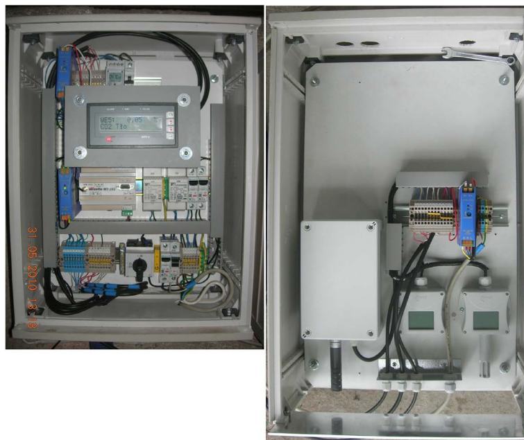
Rys. 11. Zestaw pomiarowy zabudowany w skrzynce pomiarowej: ujęcie z boku (u góry) oraz z przodu (u dołu), z dodatkowymi czujnikami (u dołu po prawej). Pracownia Geotechnologii IGSMiE PAN
