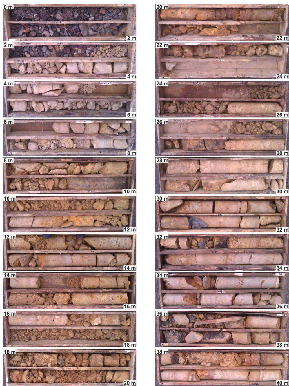
Fot. 7.3. Rdzeń wiertniczy otworu W18 w rejonie A
