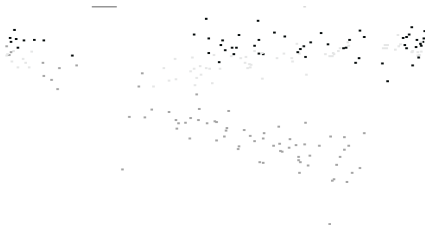
Rys. 4.17. Widok 3-wymiarowych danych powstałych z cech: wilgoć analityczna, zawartość siarki oraz ciepło spalania. Najlepszy uzyskany widok nie pozwala stwierdzić czy dane reprezentujące typ węgla 34.2 (punkty czarne) można oddzielić od danych reprezentujących typ węgla 35 (punkty jasne) – zbiory punktów reprezentujących te dwa typy zachodzą na siebie
