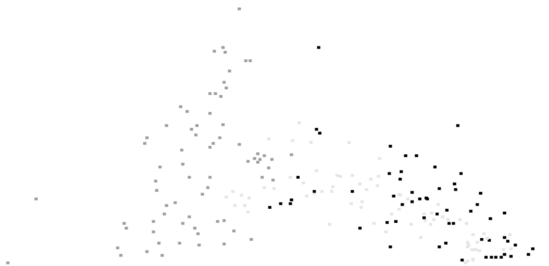
Rys. 4.16. Widok 3-wymiarowych danych powstałych z cech: wilgoć analityczna, zawartość siarki oraz ciepło spalania. Widać, że dane reprezentujące typ węgla 31 (punkty szare) zajmują inny obszar przestrzeni niż dane reprezentujące typ węgla 34.2 (punkty czarne) oraz inny obszar przestrzeni niż dane reprezentujące typ węgla 35 (punkty jasne)
