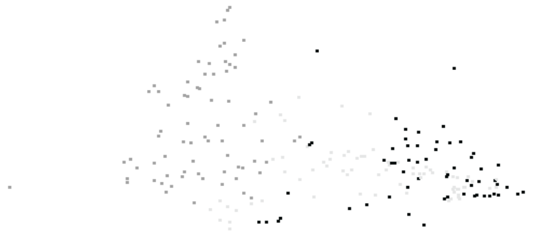
Rys. 4.18. Widok 3-wymiarowych danych powstałych z cech: wilgoć analityczna, zawartość siarki oraz zawartość popiołu. Widać, że dane reprezentujące typ węgla 31 (punkty szare) zajmują inny obszar przestrzeni niż dane reprezentujące typ węgla 34.2 (punkty czarne) oraz inny obszar przestrzeni niż dane reprezentujące typ węgla 35 (punkty jasne)
