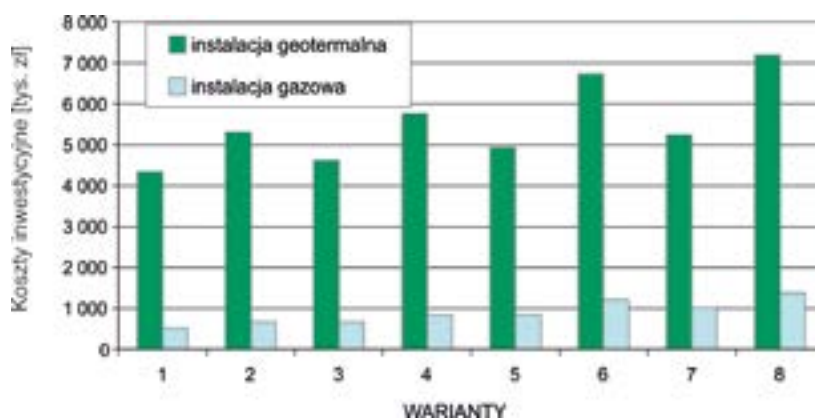
Rys. 5.5. Porównanie nakładów inwestycyjnych źródeł ciepła dla poszczególnych wariantów (tab. 5.4) (Bujakowski red. 2005)
