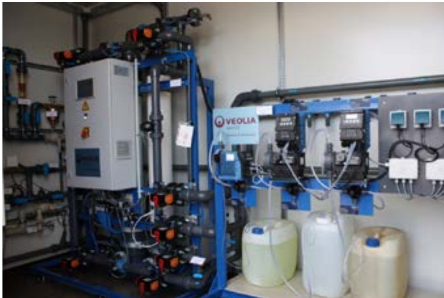
Fot. 9.4. Wyposażenie stanowiska badawczego uzdatniania wód geotermalnych (fot. B. Tomaszewska)
