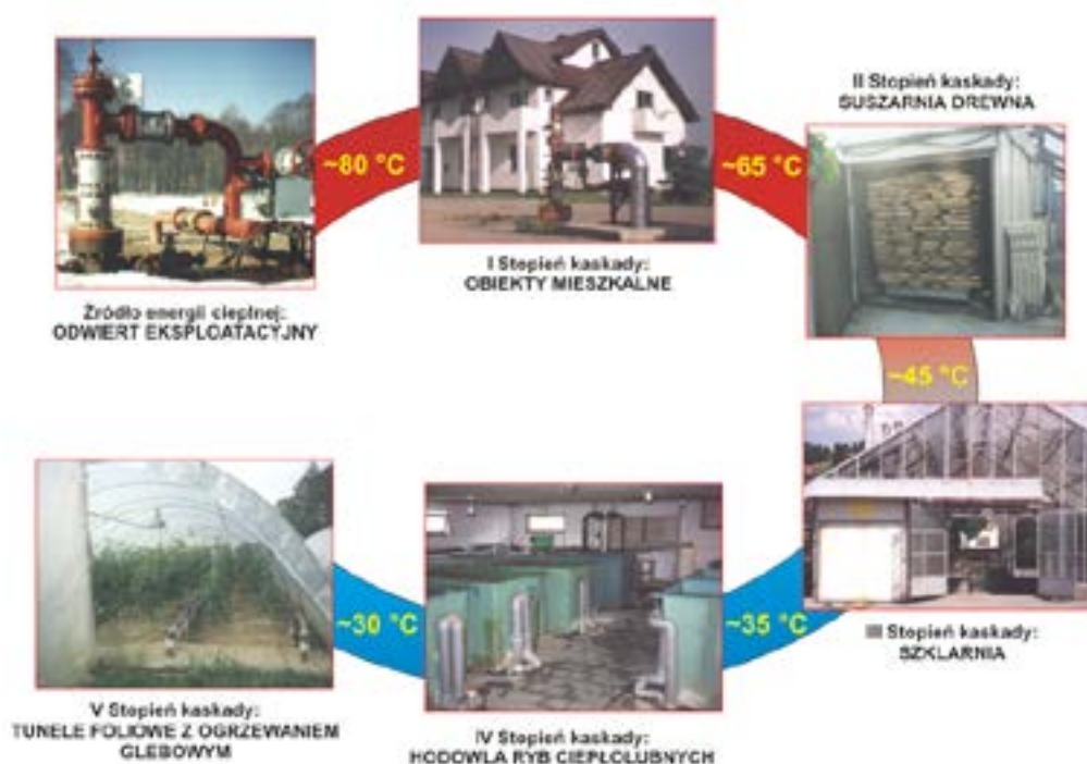
Rys. 8.5. Kaskadowy system selektywnego wykorzystania energii geotermalnej w Laboratorium Geotermalnym IGSMiE PAN na Podhalu (Bujakowski 2010)
