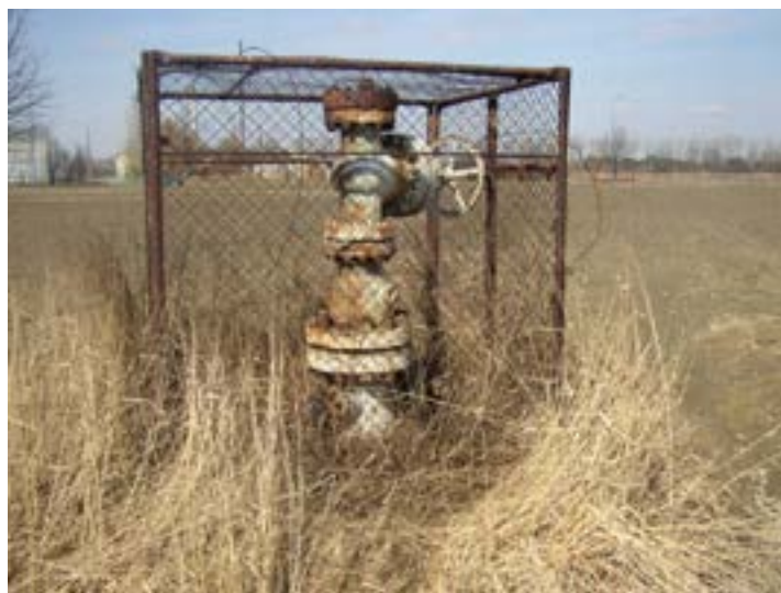
Rys. 7.3. Odwiert Skierniewice GT-1 stan po wykonaniu prac w 1991 r. (zdjęcie z 2005 r. S. Graczyka) (Praca zbiorowa pod kier. Bujakowskiego 2005c)
