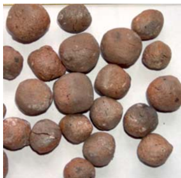
Rys. 16.5. Kruszywa sztuczne lekkie otrzymane z zastosowaniem odpadów po wzbogacaniu mułów węglowych, spiekane w temperaturze 1100°C
