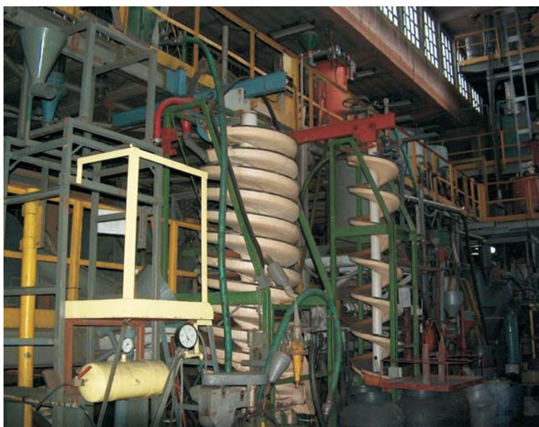
Rys. 7.2. Widok stanowiska badawczego – wzbogacalnik strumieniowy zwojowy typu Reicherta LD4
