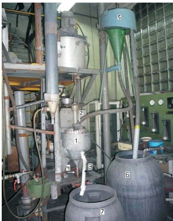
Rys. 7.5. Widok stanowiska doświadczalnego z klasyfikatorem odśrodkowym 1 – separator (klasyfikator odśrodkowy), 2 – wlot nadawy, 3 – przelew – produkt lekki, 4 – odbiór produktu ciężkiego, 5 – stożek nadawczy naporowy – zapewniający stałe określone ciśnienie nadawy, 6 – zbiornik – rzapie z pompą podającą nadawę do stożka naporowego, 7 – zbiornik produktu lekkiego (z przelewu klasyfikatora)
